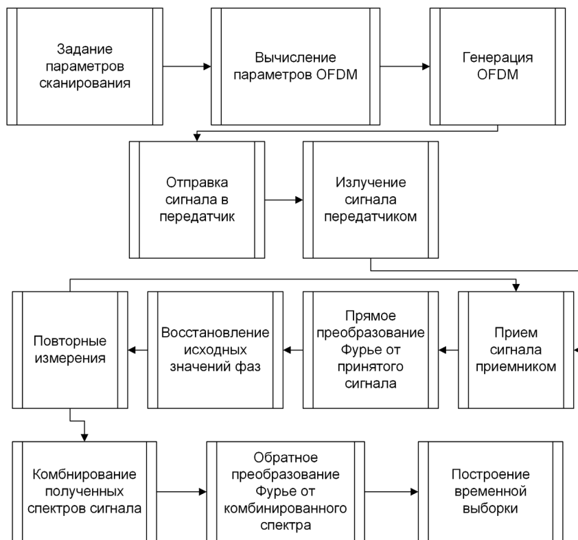
Рис. 1: Блок-схема обработки сигнала в процессоре РЛС
