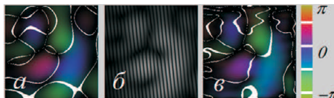
Рис. 2: Восстановление амплитудно–фазового распределения спеклового поля. a — структура заданного фрагмента спекл–поля, b — интерферограмма сдвига, в — структура восстановленного поля. Справа приведена цветовая циклическая палитра
