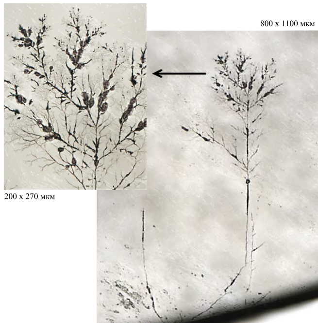
Рис. 5: Фотография разрушений, напоминающих фигуры Лихтенберга, образующихся в эпитаксиальных слоях GaN при облучении СЭП ( H \sim 0.2 Дж/см 2 ). На вставке — увеличенная фотография «дерева разряда».
