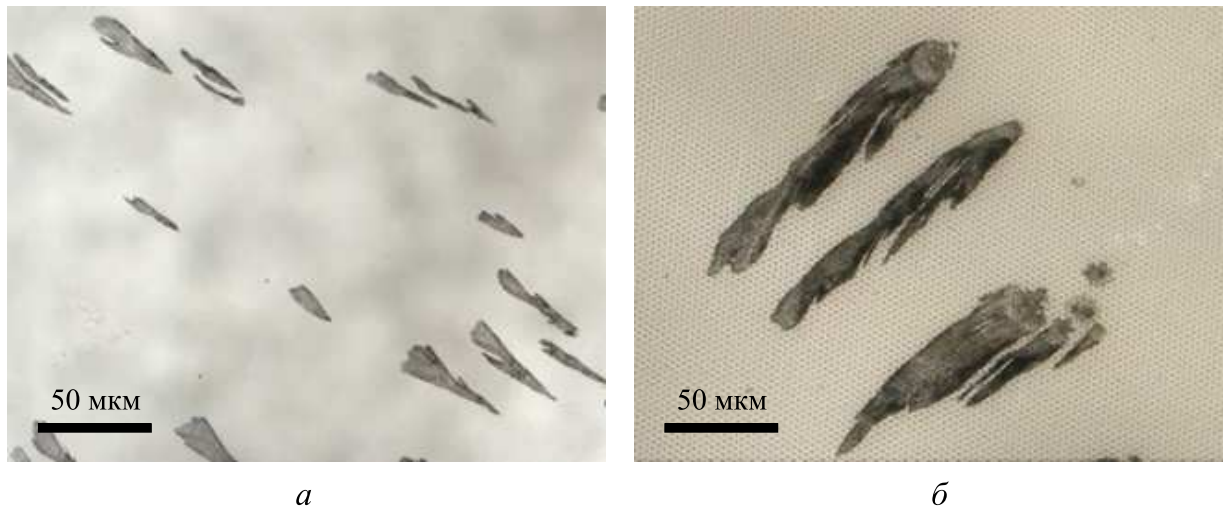
Рис. 3: Фотографии микроразрушений двух светодиодных структур, в которых регистрировалось стимулированное излучение InGaN-квантовых ям [15], после 100 импульсов облучения СЭП при H = 0.25 Дж/см 2 .
