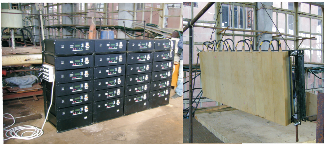
Рис. 3: Гидроакустическая параметрическая антенна для гидрофизических исследований на протяженных трассах. Слева — 24-канальный усилитель мощности антенны. Мощность каждого канала — 6 кВт
