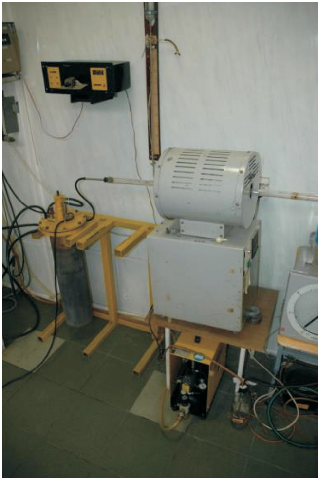
Рис. 1: Установка для азотирования поверхности деталей
