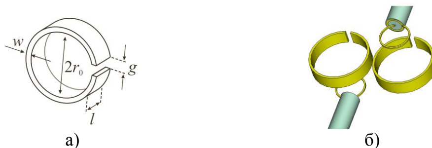
Рис.1. а) Схематичное изображение расщепленного кольцевого резонатора для ГГц диапазона. Внутренний радиус r_0=10 мм, высота l=5 мм, толщина w=1 мм, ширина щели g=1 мм. Резонансная частота элемента 1.81 ГГц. б) Схематичное изображение конфигурации двух кольцевых резонаторов и двух антенн (излучающей и приемной) для экспериментального определения коэффициента взаимодействия
