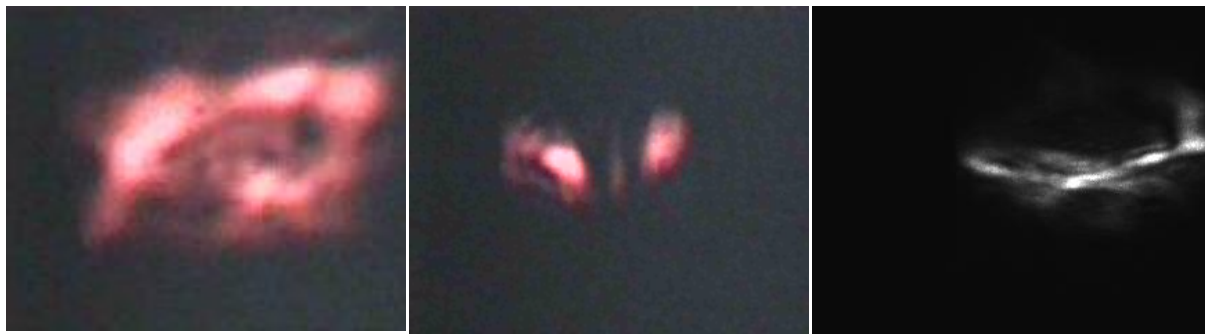
Рис. 1. Распределение интенсивности для пучка с высокой пространственной когерентностью (слева), «бинарного пучка» (центр) и пучка с низкой степенью когерентности (справа)
