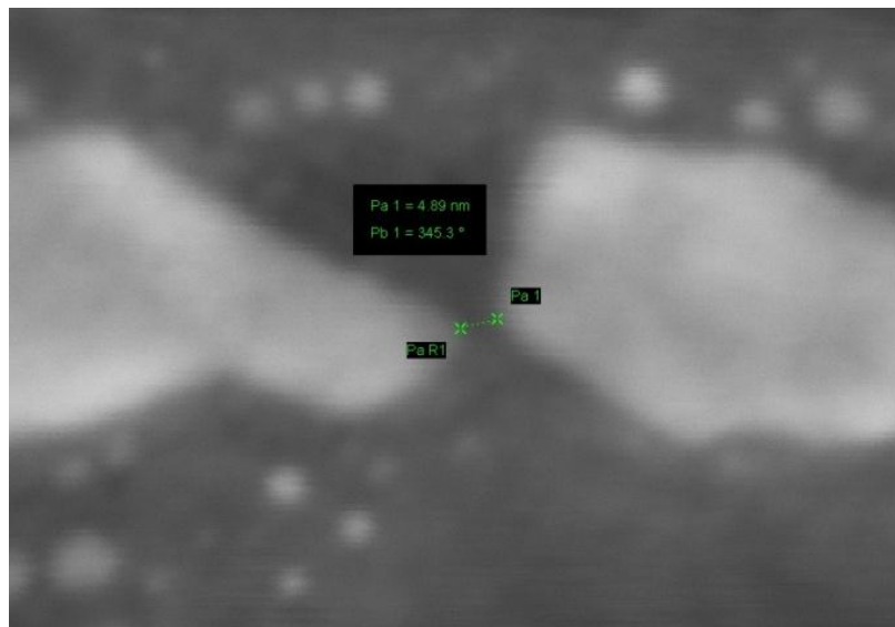
Рис.1. Зазор между нанoeлектродами величиной 4.9 нм, полученный при помощи метода электромиграции
